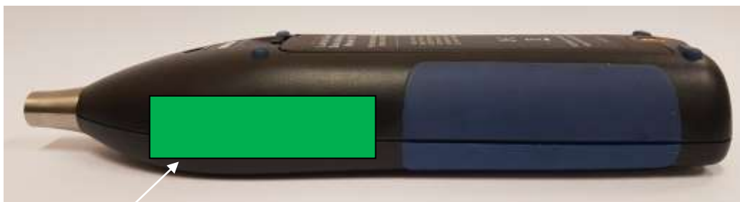
Emplacement de la marque de contrôle en service
